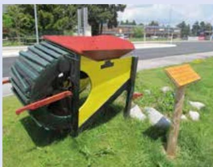
Il servait à séparer le grain de l'enveloppe et autres impuretés de la paille. Il était activé manuellement par la manivelle.
